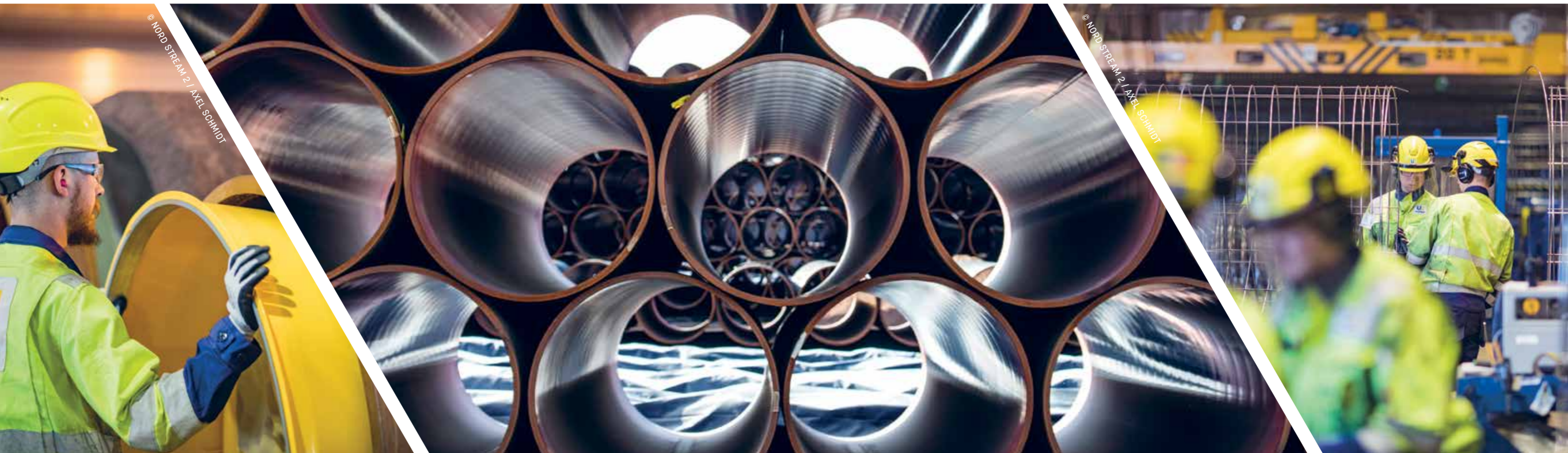
Betonipäällystystä Kotkassa: suojakorkit asennetaan varastointia varten.
